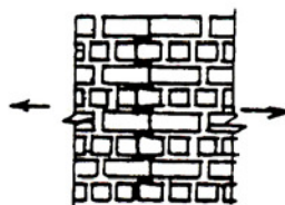
Hình 2 : Khối xây chịu kéo theo mạch giằng
